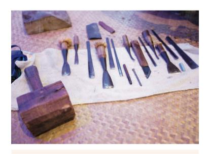
อุปกรณ์ที่สำคัญในการแกะสลักและจำหลักไม้ Wood Carving Hand Tools
