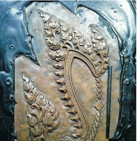
การขึ้นรูป ตัดแผ่นโลหะเพื่อนำมาขึ้นรูปตามแบบที่ต้องการ และ ขึ้นลาย ด้วยวิธีสลักดุน
